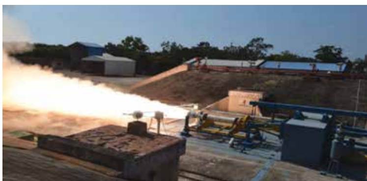
उच्च तुंगता वाली पलायन मोटर का स्थैतिक परीक्षण
