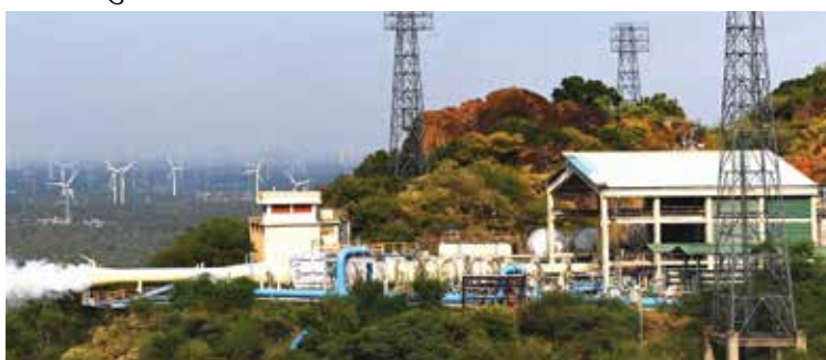
टैंक शीर्ष परिस्थिति के तहत बूस्ट स्ट्रैप मोड में सी.ई.20 इंजन का पुनःप्रज्वलन अभिलक्षणन तप्त परीक्षण
