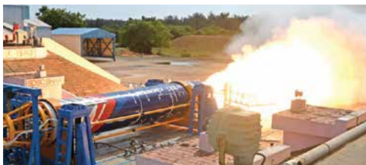
विक्रम-1 के चरण-1 मोटर का स्थैतिक परीक्षण
