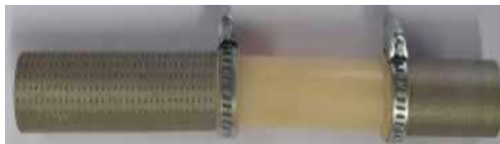
सैक अहमदाबाद के परामर्श के साथ एन.आई.टी. तिरुचिरापल्ली में एस.आई.टी. द्वारा विकसित नम्य उष्मा पाइप
