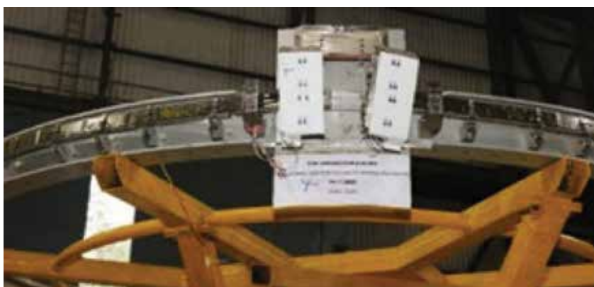
कर्मिदल मॉड्यूल फेयरिंग पृथक्करण प्रणाली का प्रकार्यात्मक परीक्षण
