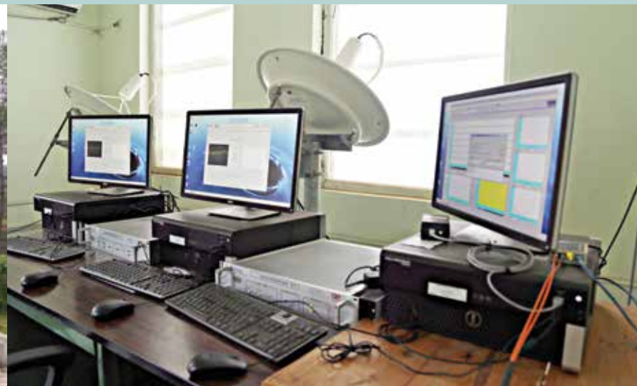
इसरो-सीएनईएस-ओएनईआरए संयुक्त केए बैंड प्रसार परीक्षण के लिए आंकड़ा संग्रह प्रणाली Data Collection System for the ISRO-CNES-ONERA joint Ka-band Propagation Experiment
