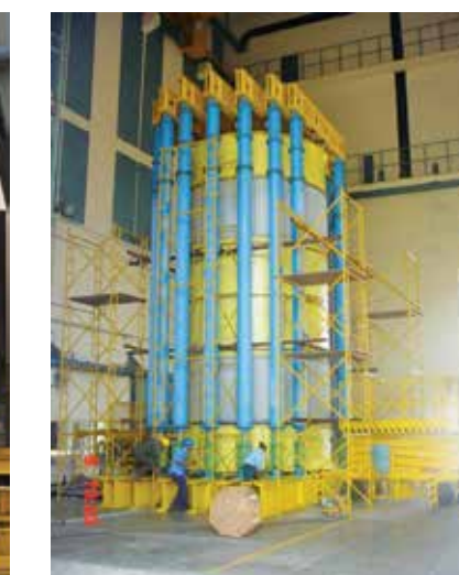
यू टैंक स्ट्रक्चरल टेस्ट U Tank Structural Test
