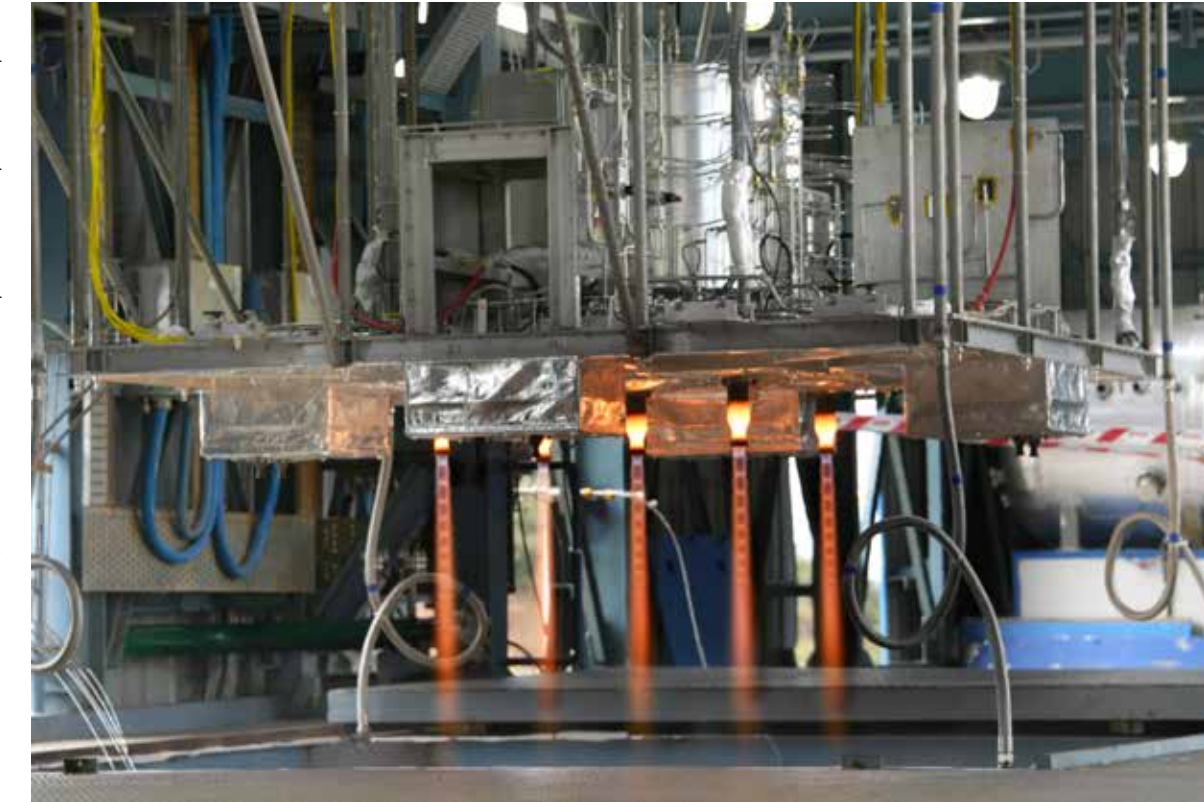
गगनयान एस.एम.पी.एस.-एस.डी.एम. परीक्षण Gaganyaan SMPS-SDM Test
