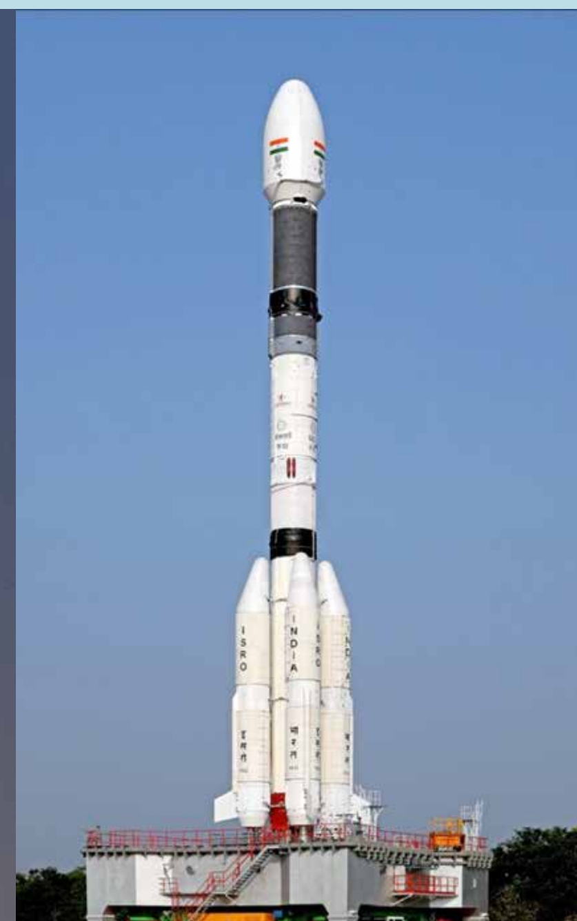
4 मीटर व्यास वाला जीएसएलवी ओगिव नीतभार फेयरिंग GSLV with 4 m diameter Ogive Payload Fairing
