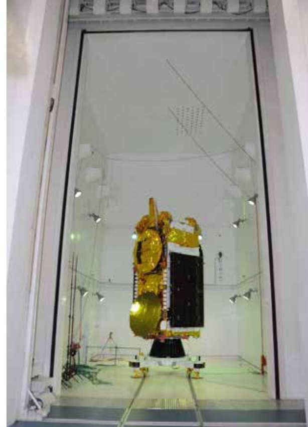
ध्वनिक परीक्षण से गुजरता उपग्रह Satellite Undergoing Acoustic Test
