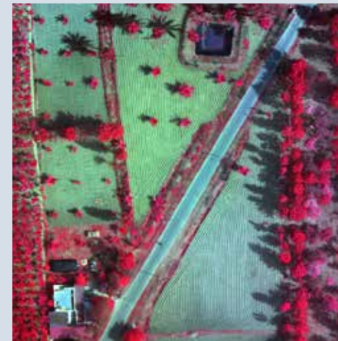
यू.ए.वी. प्लेटफॉर्म से बहु वर्णक्रमीय चित्र (8cm जी.एस.डी.) Multispectral Image (8cm GSD) from UAV Platform
