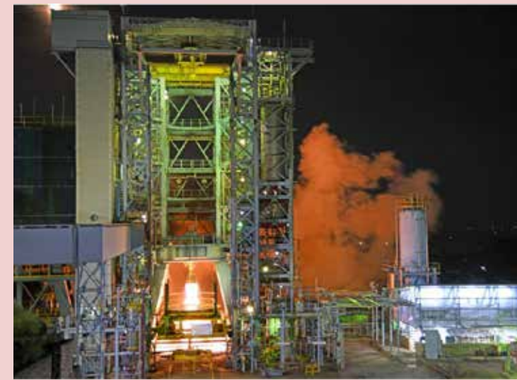
पीटीएस में विकास इंजन का परीक्षण Testing of VIKAS Engine at PTS
