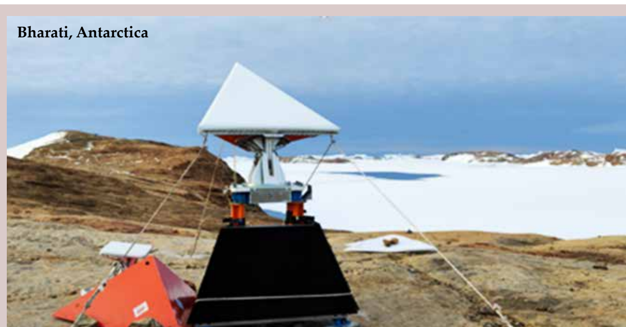
Bharati, Antarctica अंटार्कटिका (सिंथेटिक अपचर रडार (सार) अंशाकन स्थल (कैलिब्रेशन साइट) पर स्थापित कॉर्नर रिफ्लेक्टर
