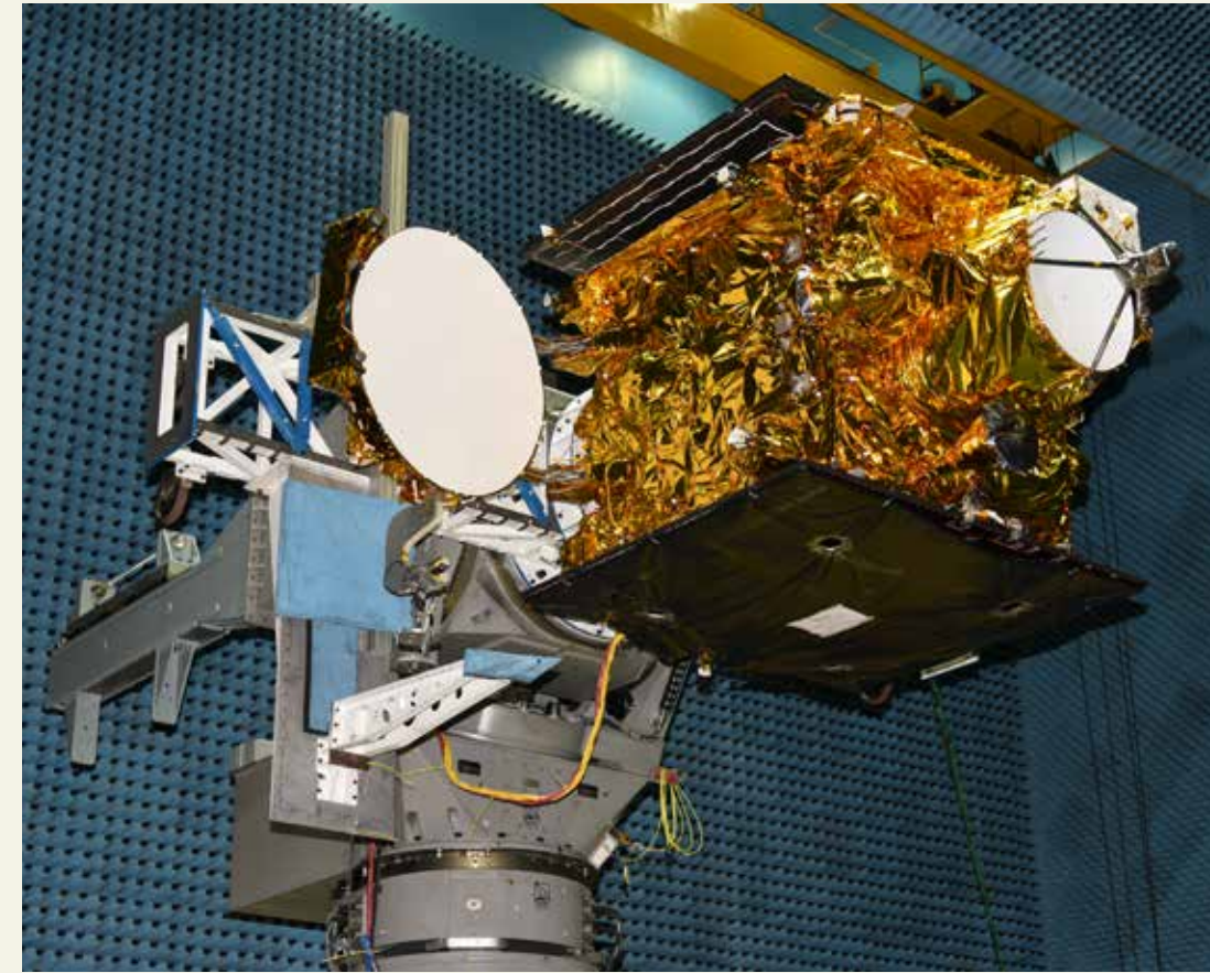
कॉम्पैक्ट ऐन्टेना परीक्षण सुविधा Compact Antenna Test Facility Testing
