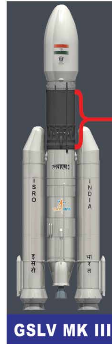
सी25 चरण का समग्र संरूपण एवं विनिर्देश Overall configuration & specifications of C25 stage
