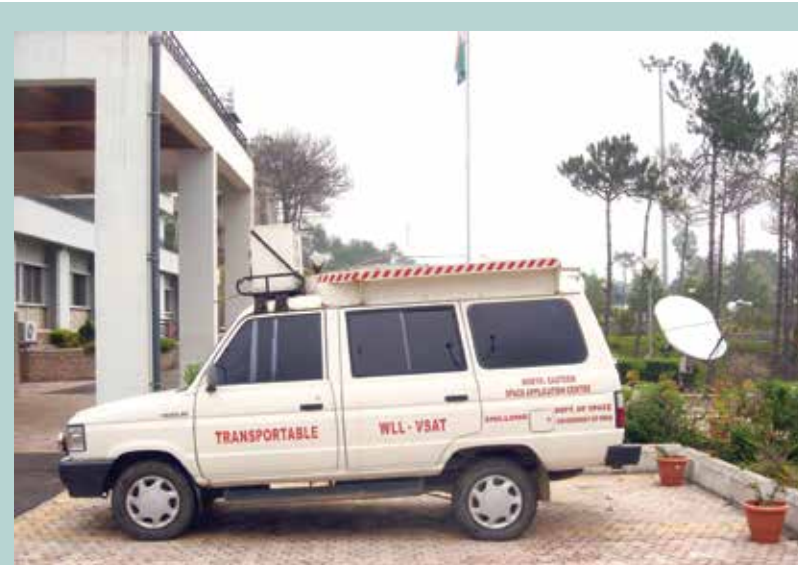
आपातकालीन दूरसंचार उपलब्ध कराने के लिए आने-जाने योग्य वीसैट प्रणाली The transportable VSAT System for providing Emergency Communication
