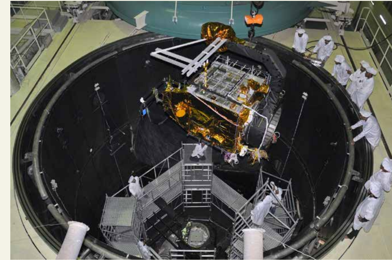
थर्मोवैक परीक्षण के लिए बृहत् अंतरिक्ष अनुकरण पर लोड किया जाता एमओएम MOM loading to Large Space Simulation Chamber for Thermovac Testing
