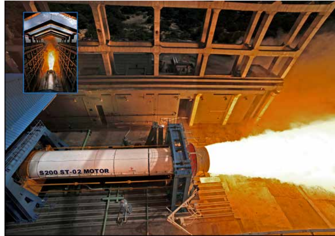
एस 200 6 सी सुविधा में एक स्थिर परीक्षण S200 Static Test at 6C Facility
