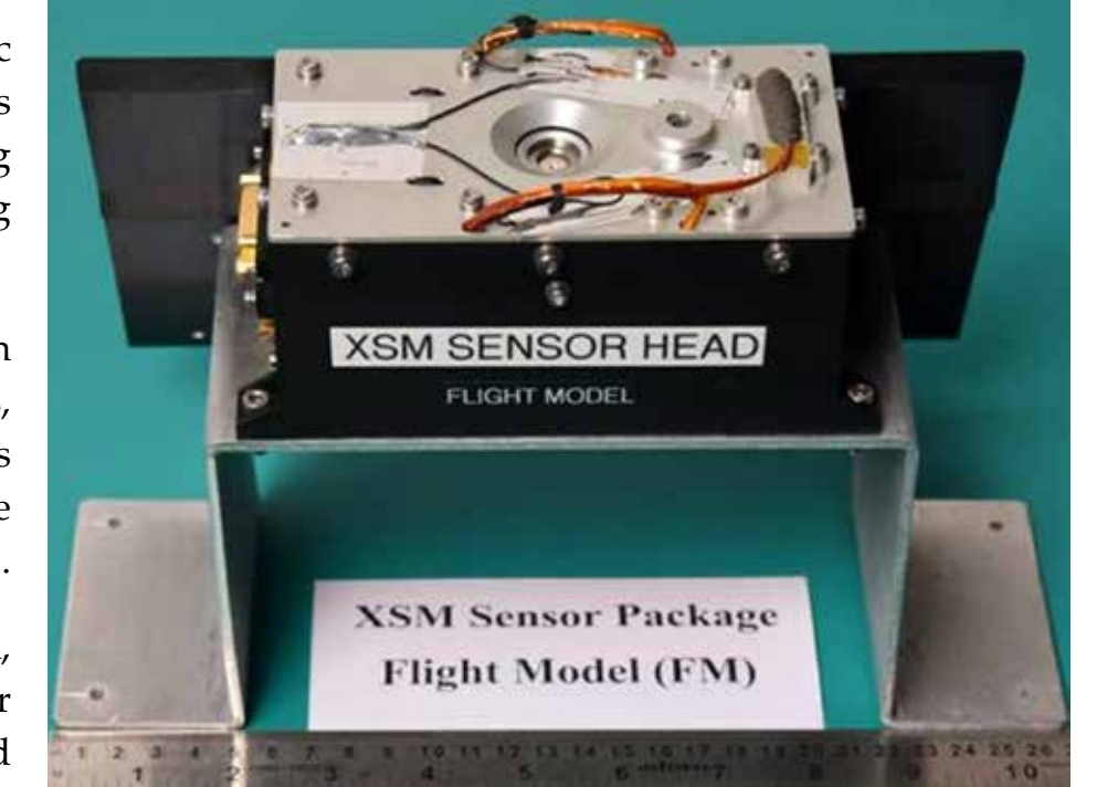
सौर एक्स-रे मॉनिटर (XSM) संवेदक पैकेज Solar X-ray Monitor (XSM) Sensor Package
