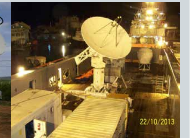
पीएसएलवी-सी25/एमओएम मिशन का समर्थन करने के लिए जहाज पर तैनात परिवहन योग्य टर्मिनल Transportable Terminal deployed on a Ship to support PSLV- C25/ MOM mission
