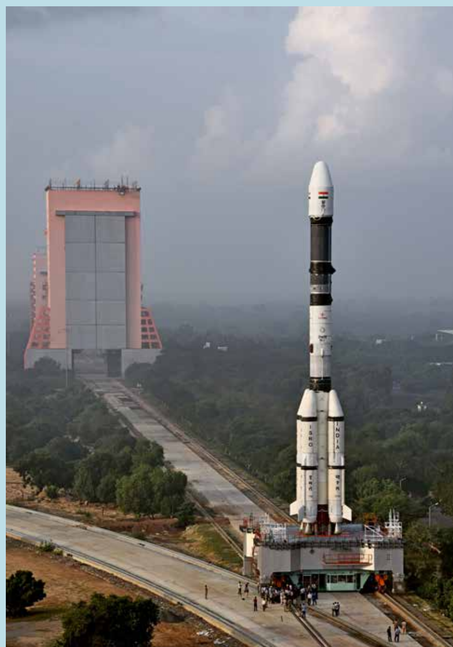
3.4 मीटर व्यास नीतभार फेयरिंग के साथ जीएसएलवी GSLV with 3.4 m diameter Payload Fairing
